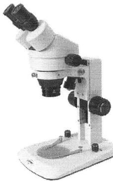
Coluna (Braço) que incorpora o sistema macrométrico e o suporte do cabeçote binocular.
