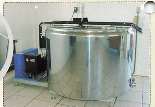
Resfriador de leite em aço inox 304 de 300 a 20.000 litros.
