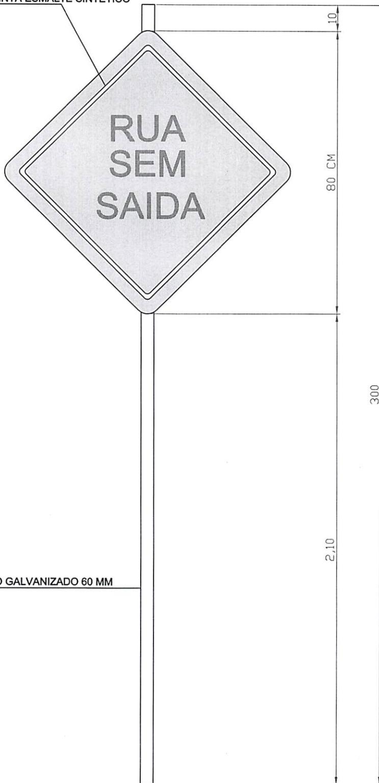
TUBO DE AÇO GALVANIZADO 60 MM
